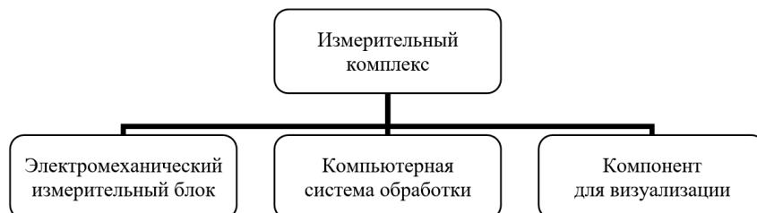
Рисунок 1. – Структурная схема измерительного комплекса
