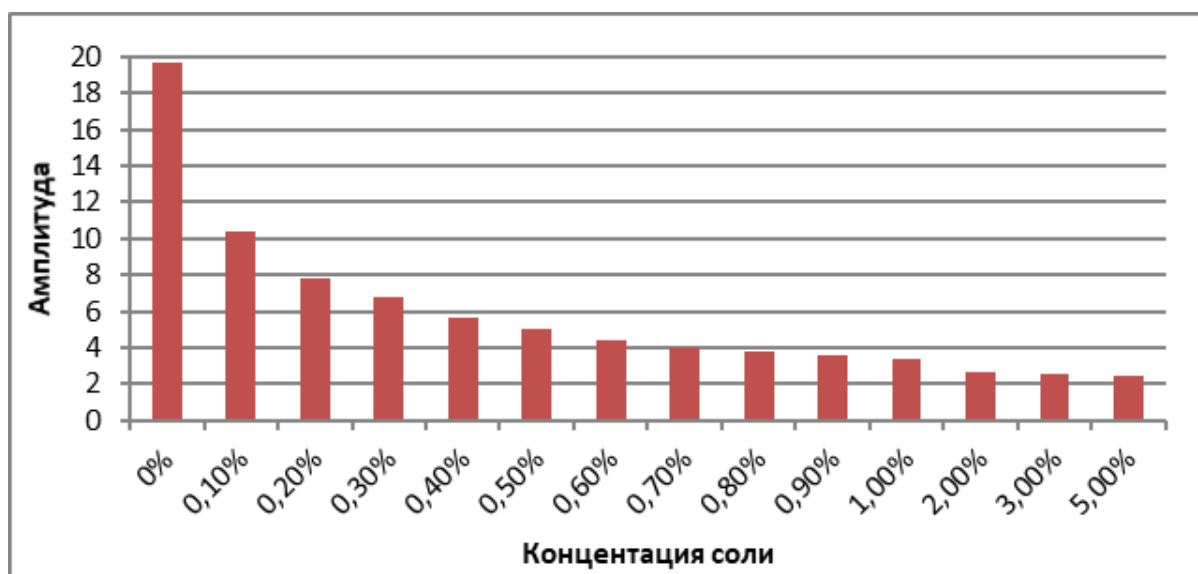
Рисунок 5. – Амплитуды и собственные частоты образцов воды с различной концентрацией соли
