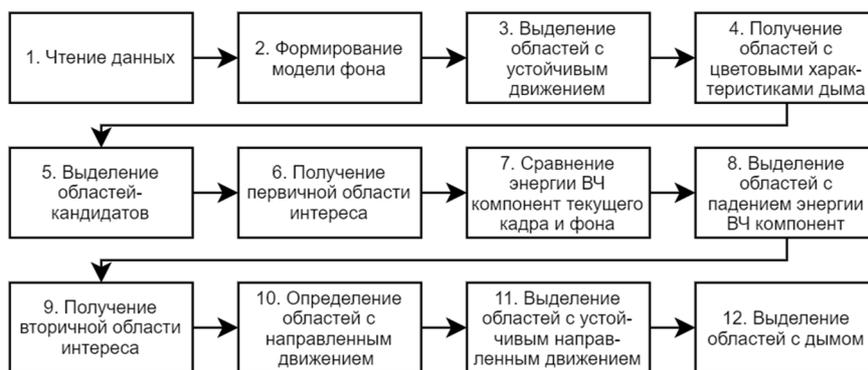
Рисунок 1. – Блок-схема алгоритма детектирования дыма
