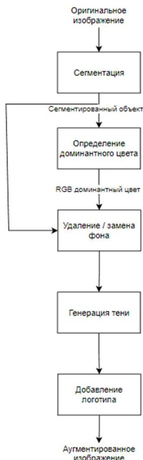
На вход алгоритма поступает оригинальное RGB-изображение. На первом этапе происходит сегментация изображения, выделенный объект далее передается на вход модуля определения доминантного цвета и модуля замены фона. Определение доминантного цвета необходимо, чтобы при замене фона избежать ситуации, когда объект полностью с ним сливается. Затем происходит генерация одного из трех типов тени: зеркальной, падающей или реалистичной. В конце на полученное изображение добавляется логотип.
