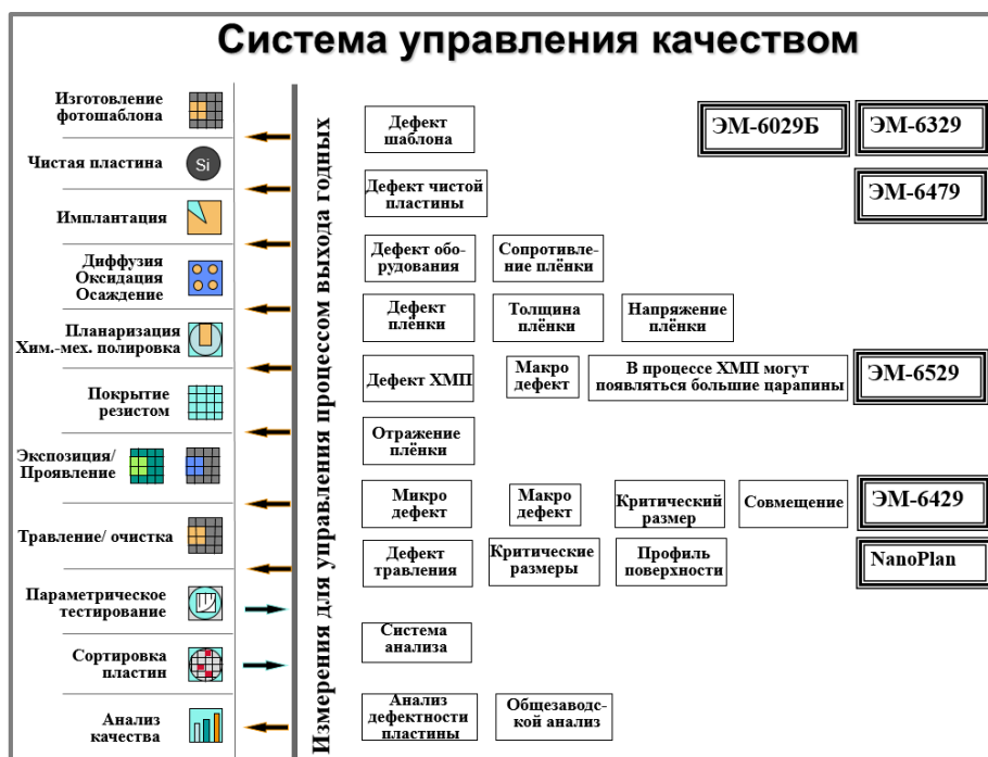
Рисунок 4. – Контрольно-измерительное оборудование ОАО «Планар» для системы управления качеством полупроводниковых пластин
