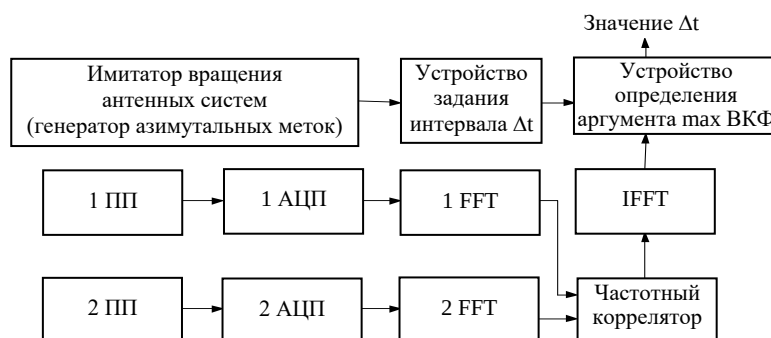
Рис. 2. Структурная схема устройства быстрого обзора по разности хода
