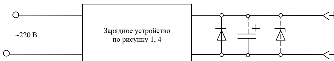
Рис. 5. Зарядное устройство в режиме непосредственного электропитания с использованием ограничительных нелинейных элементов
