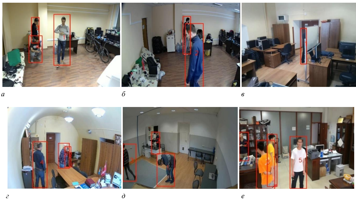
Рисунок 5. – Примеры сопровождения множества людей с нелинейной траекторией движения в помещении с использованием стационарной видекамеры
