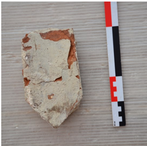
Малюнак 5. – Лекальная плінфа, якая выкарыстоўвалася для будаўніцтва паэрэбрыка
