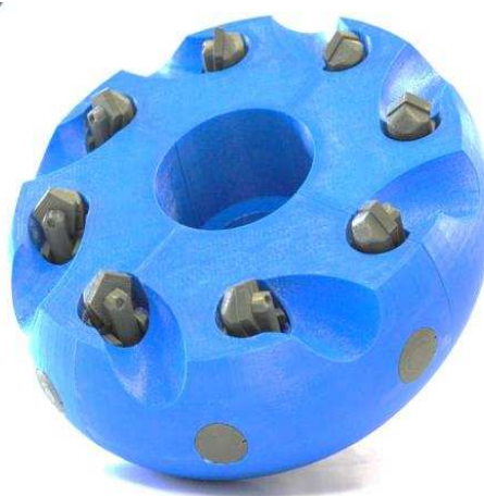
Рисунок 5. – Макет БМТФ обтекаемой формы, выполненный с применением трехмерной печати
