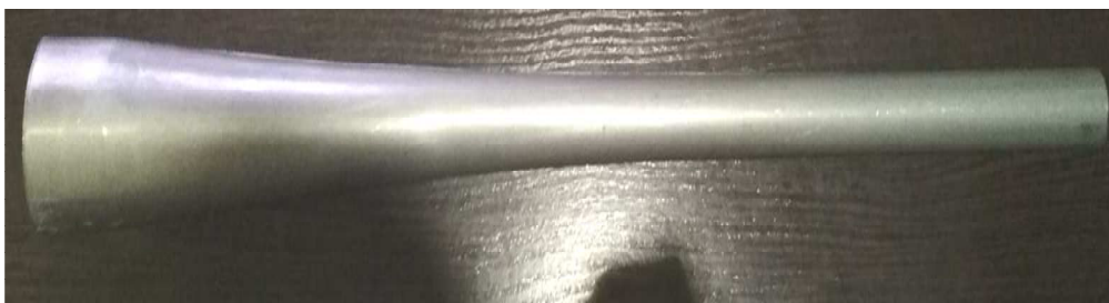
Рисунок 5. – Конус деформации (рабочий конус) стана ХПТ-55 (сталь TP316L, маршрут 57×6,0 → 25×2,5)
