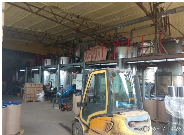
Рисунок 5. – Технологический модуль РС 200-01/18 для подготовки компонентов (а) и участок по производству биоразлагаемых смазочных материалов на базе реактора-смесителя РС 2200-04/18 (б)
