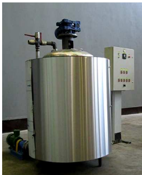
Рисунок 5. – Технологический модуль РС 200-01/18 для подготовки компонентов (а) и участок по производству биоразлагаемых смазочных материалов на базе реактора-смесителя РС 2200-04/18 (б)
