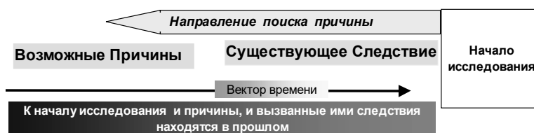
Рисунок 1. – Схема поиска причины способом «от следствия к причине» 1
