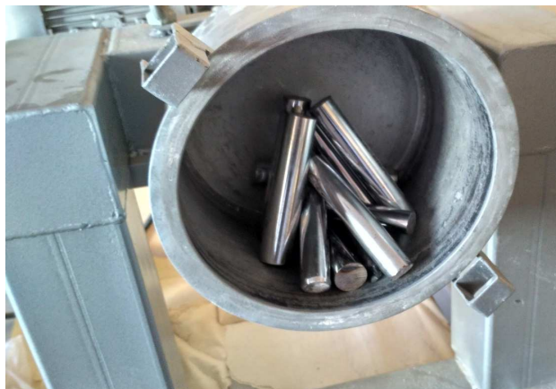
Рисунок 1. – Лабораторная барабанная мельница с цилиндрическими мелющими телами
