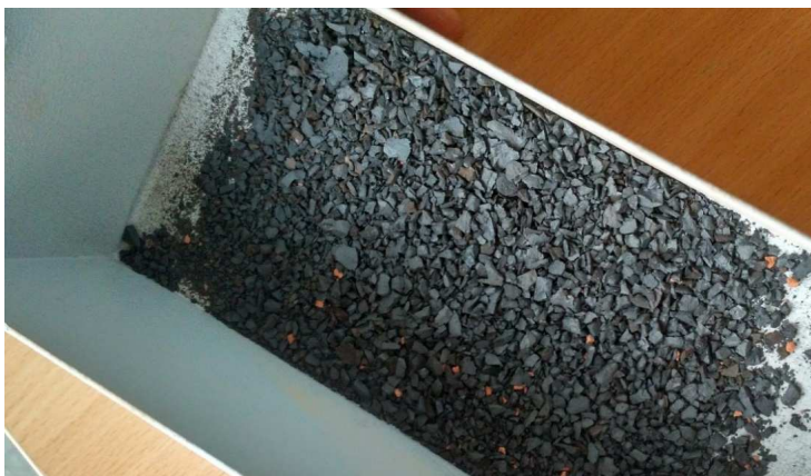
Рисунок 2. – Измельченный кокс в выгрузном бункере щековой дробилки
