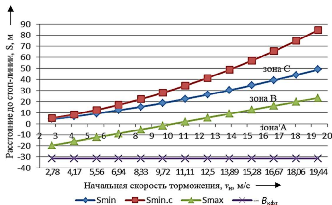
Рисунок 4. – Зависимость расстояния до стоп-линии от начальной скорости торможения автомобиля (при различных значениях скоростей)
