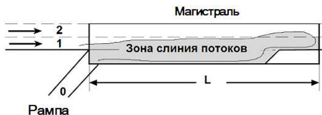
Рисунок 1. – Схема образования затора в зоне слияния потоков
