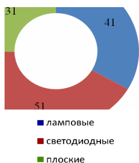
Рисунок 5. – Распределение переходов по виду светосигнальных устройств светофоров для транспорта
