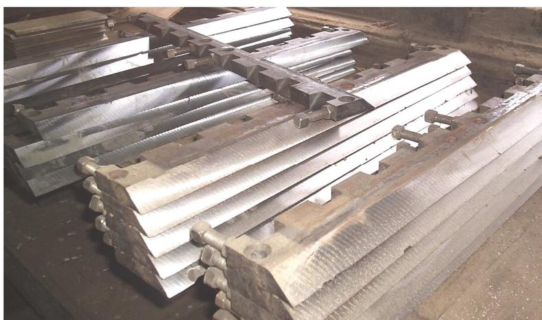
**Рисунок 4 – Опытные образцы ножей для рубки щепы ФТИ5.001.1675**
