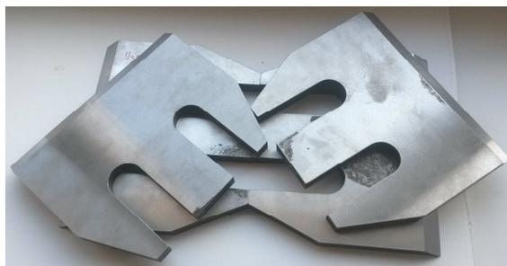
**Рисунок 3 – Опытные образцы ножей для рубки щепы ФТИ5.001.1685**
