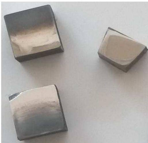
Рисунок 5 – Шлифы из опытных образцов ножей
