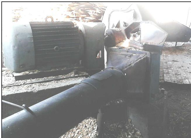
Рисунок 1 – Рубительная машина МРГ-20 на ОАО «Минскдрев»
