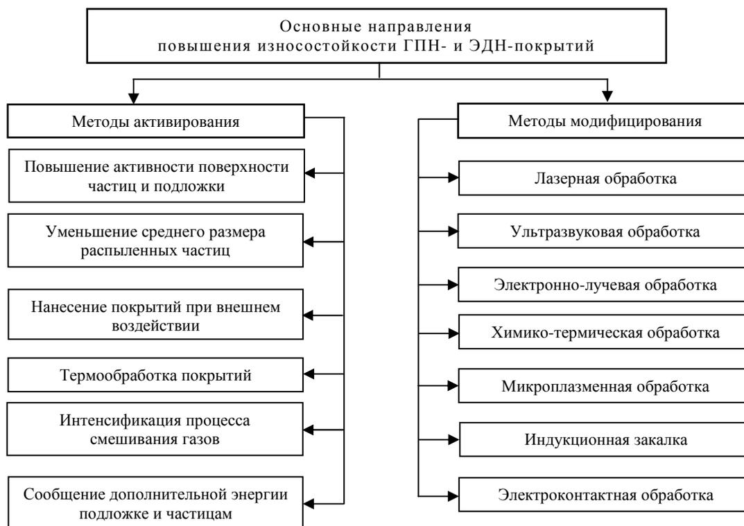
Рисунок 3 – Основные направления повышения износостойкости ГПН- и ЭДН-покрытий
