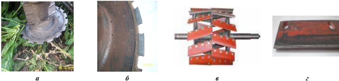
Рисунок 6 – Ножи с покрытиями свеклоуборочных машин (а, б) и измельчительного барабана (в, г) комбайна
