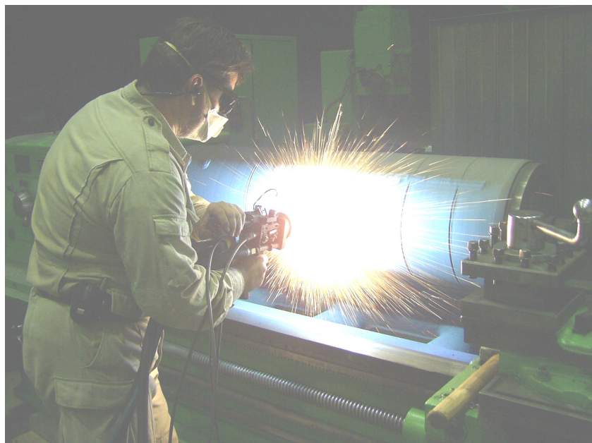
Рисунок 3 – Процесс напыления покрытия методом гиперзвуковой металлизации на пиноль задней бабки станка 1А670
