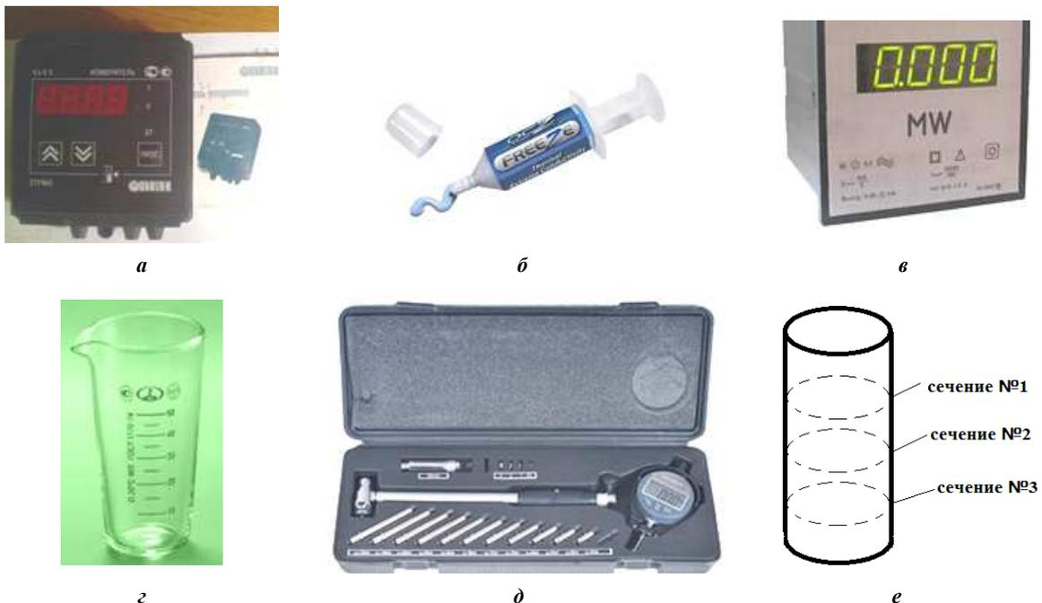
а – микропроцессорный программируемый измеритель типа 2ТРМОА-Щ1.ТП;
