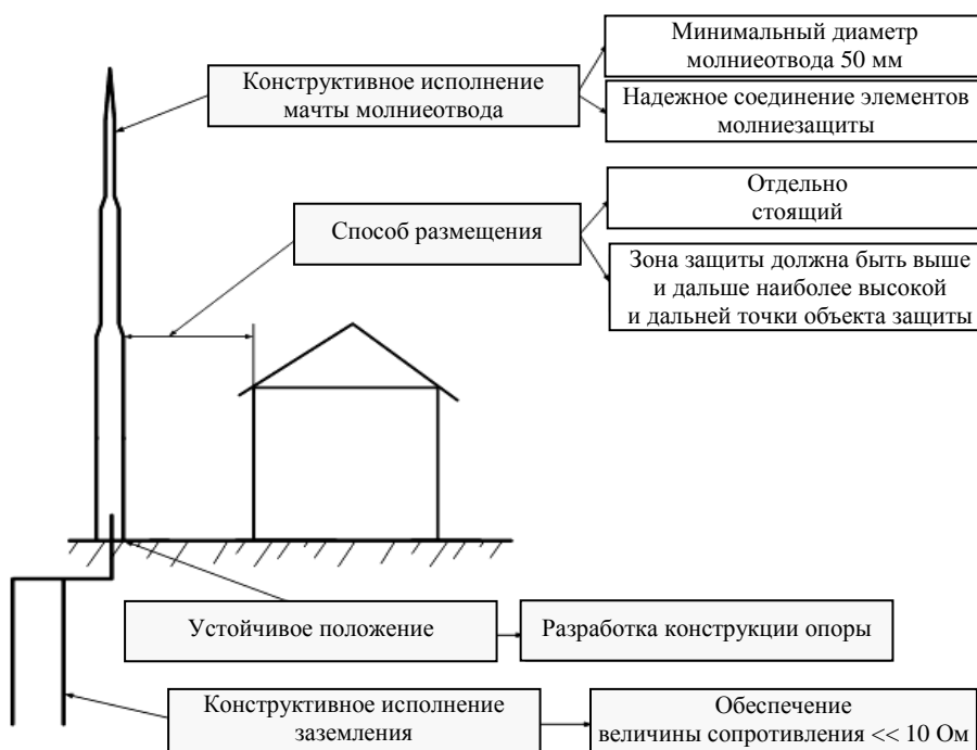
Рисунок 1. – Взаимосвязь и взаимовлияние элементов системы «молниеотвод – производственная среда – объект защиты»
