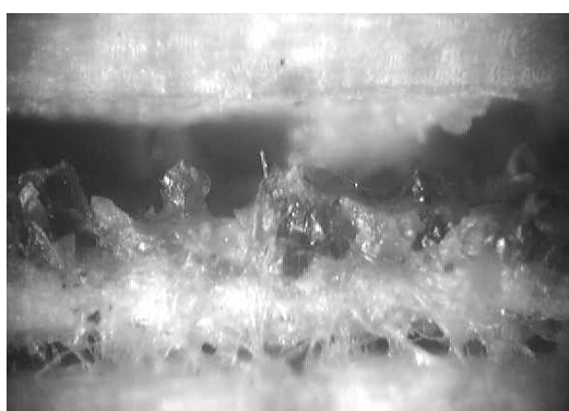
Рисунок 1. – Образец покрытия с ориентированными зернами абразива
