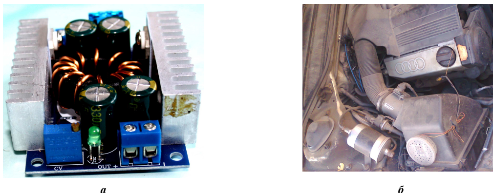
Рисунок 6. – Преобразователь марки 14-59И ПМ (а) для регулируемой подачи постоянного напряжения от +12 В до +50 В; б – монтаж преобразователя в пластмассовом перфорированном барабане на корпусе воздухофильтра, отвод проводов на головку блока цилиндров и к масломерному щупу
