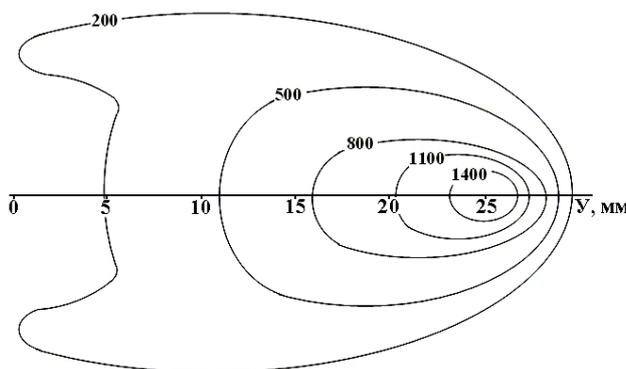
Рисунок 1. – Распределение температур поверхности свариваемых деталей (изотермы)
