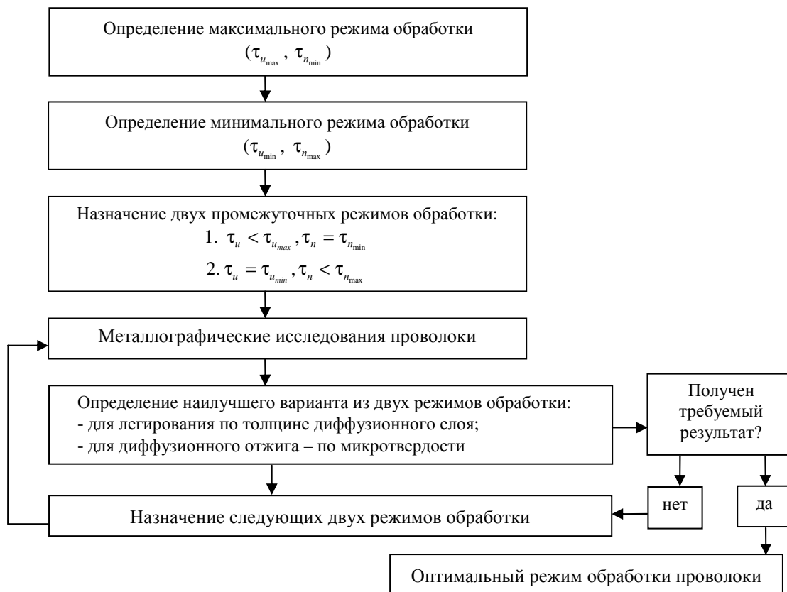
Рисунок 2. – Методика оптимизации режимов диффузионного легирования и диффузионного отжига проволоки в условиях циклического электронагрева
