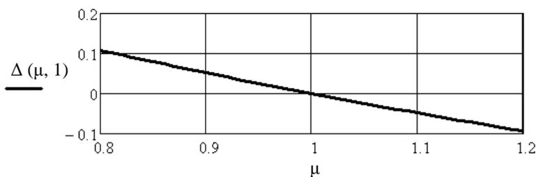
**Рисунок 2. – Зависимость величины относительной погрешности определения частотного коэффициента от степени разномодульности материала балки**
