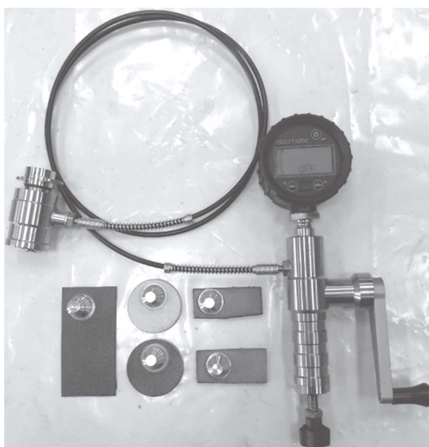
Рисунок 1. – Внешний вид адгезиметра ELCOMETER 506 с образцами
