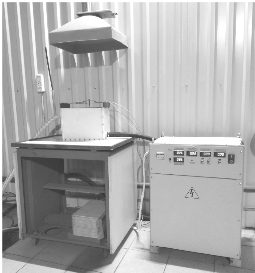
Рисунок 6. – Установка микродугового оксидирования газотермических покрытий
