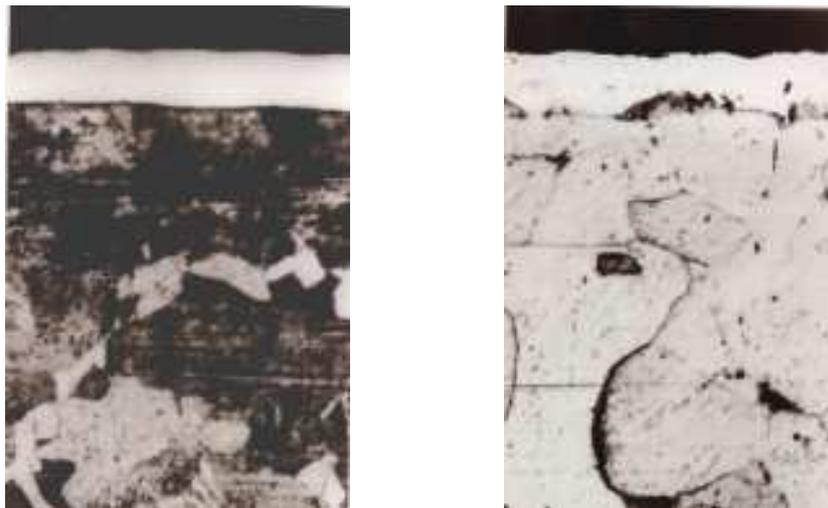
Рис. 3. Микроструктуры хромированных слоёв ( $\times 200$ )
