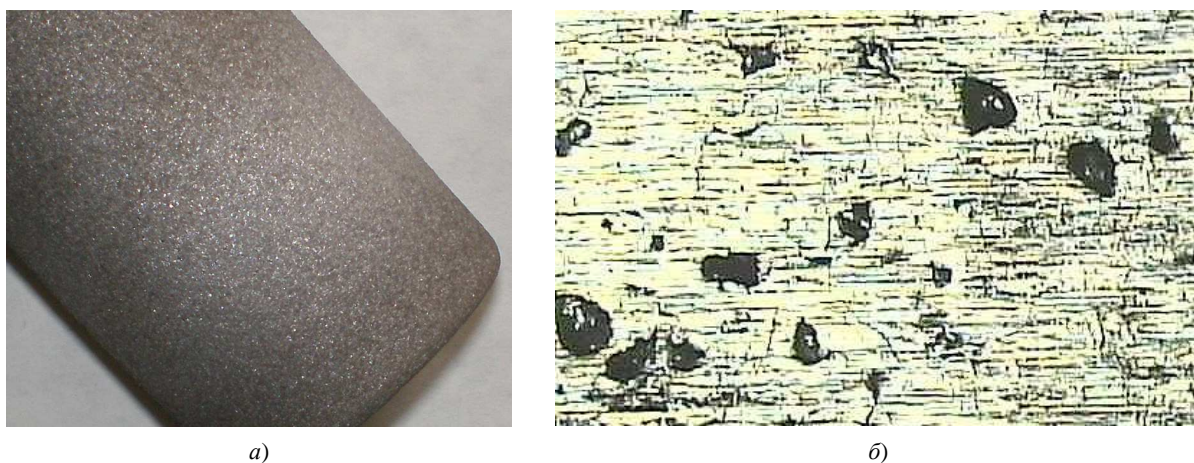
Рис. 6. Внешний вид напыленного покрытия (а) и поверхность после шлифования ( \times 200 )
