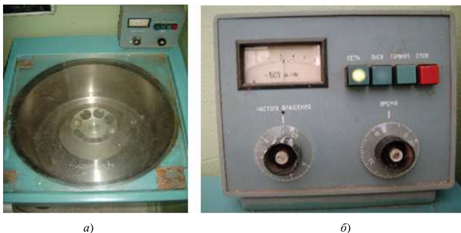
Рис. 1. Центрифуга лабораторная медицинская ОС-6М: а – общий вид центрифуги; б – пульт управления
