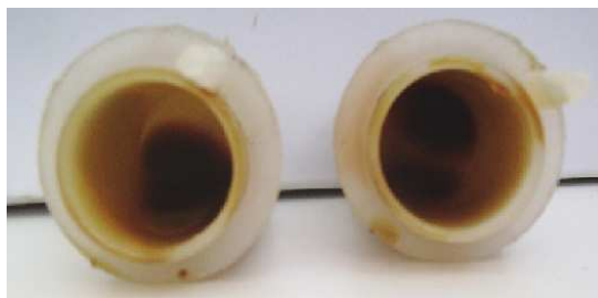
Рис. 2. Пробирки с остатками солидола
