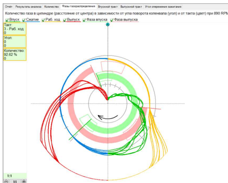
Рисунок 4. – Вкладка «фазы газораспределения» теста Rx
