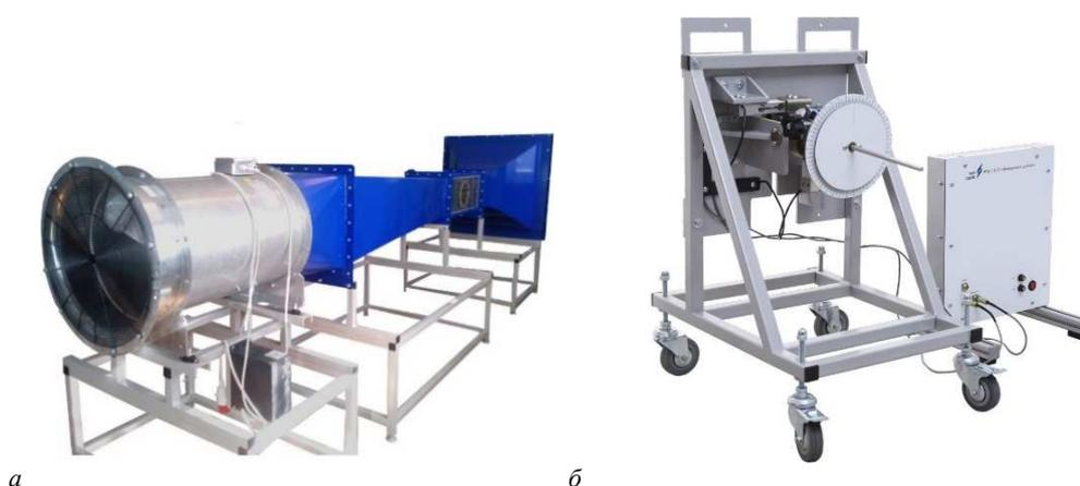
**а – компоновка стенда; б – тензометрические аэродинамические весы**
