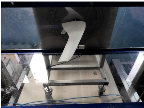
Рисунок 4. – Обдуваемая модель, установленная на консоль аэродинамических весов лабораторного стенда НТЦ-19.02 «Аэродинамическая труба»
