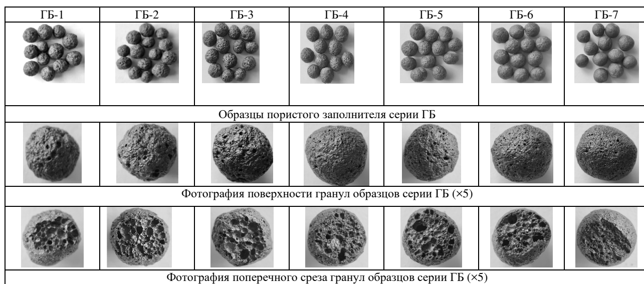
Рисунок 3. – Фотографии вспученных образцов пористых заполнителей серии ГБ, поверхности гранул и их поперечных срезов
