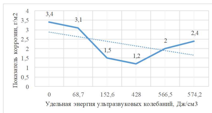
Рисунок 1. – Влияние величины удельной энергии ультразвуковых колебаний, переданной высокощелочному сульфату на антикоррозионную активность пакета присадок
