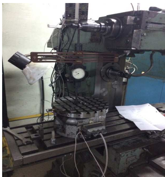
Рисунок 4. – Процесс калибровки оси Z
