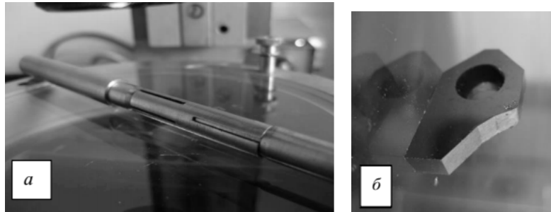
Рисунок 6 – Самоцентрирующийся пилот со съемной лепестковой цангой (а), режущая профильная пластина (б)
