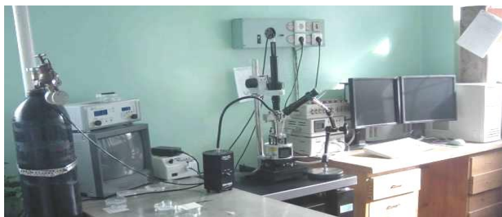
Рис. 2. Атомно-силовой микроскоп «Nanoscope 3D» производства США
