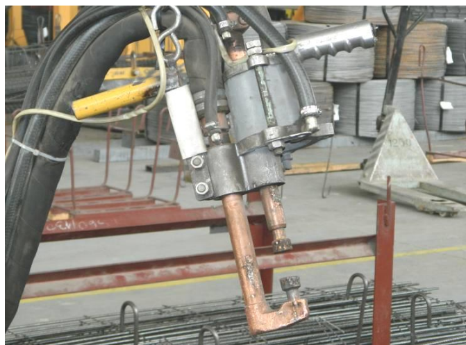
Рис. 1. Внешний вид сварочных клещей КТП-8-7
