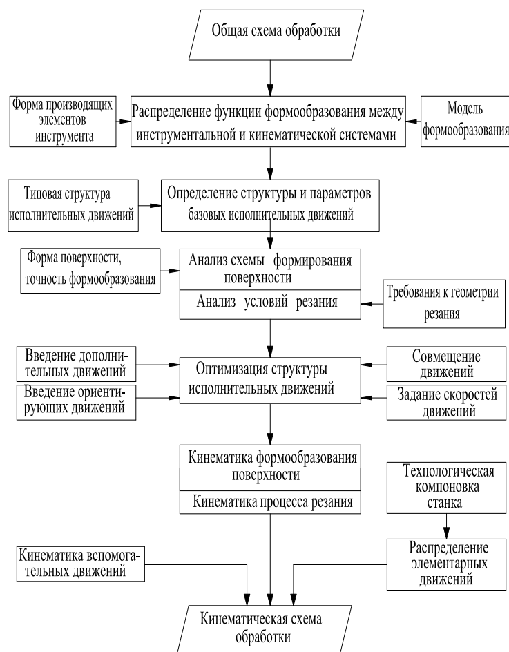
Рис. 5. Алгоритм синтеза кинематической схемы обработки
