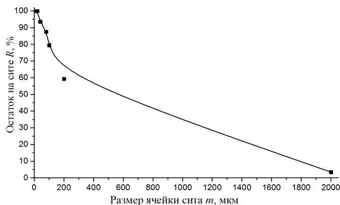
Рисунок 3. – Фракционный состав измельченного стекла при помоле в барабанной шаровой мельнице
