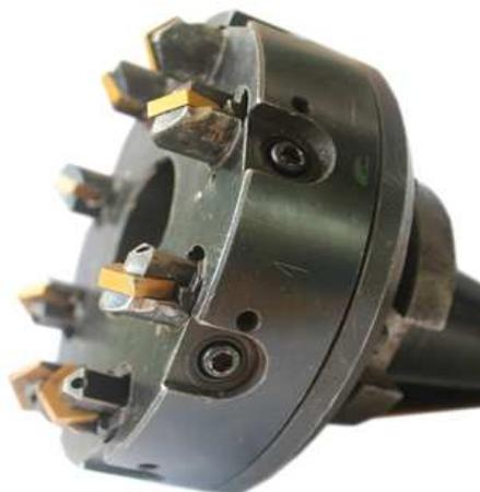
**Рисунок 4. – Опытный образец БМТФ с «утопленными» блоками**
