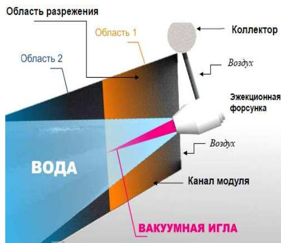
Рисунок 3. – Принцип работы эжекционной форсунки
