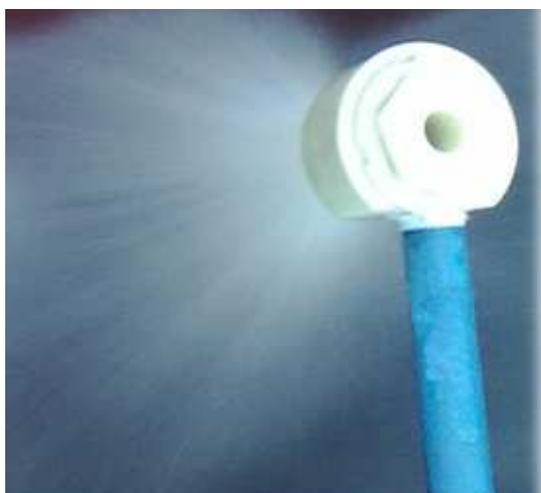
Рисунок 2. – Эжекционная форсунка
