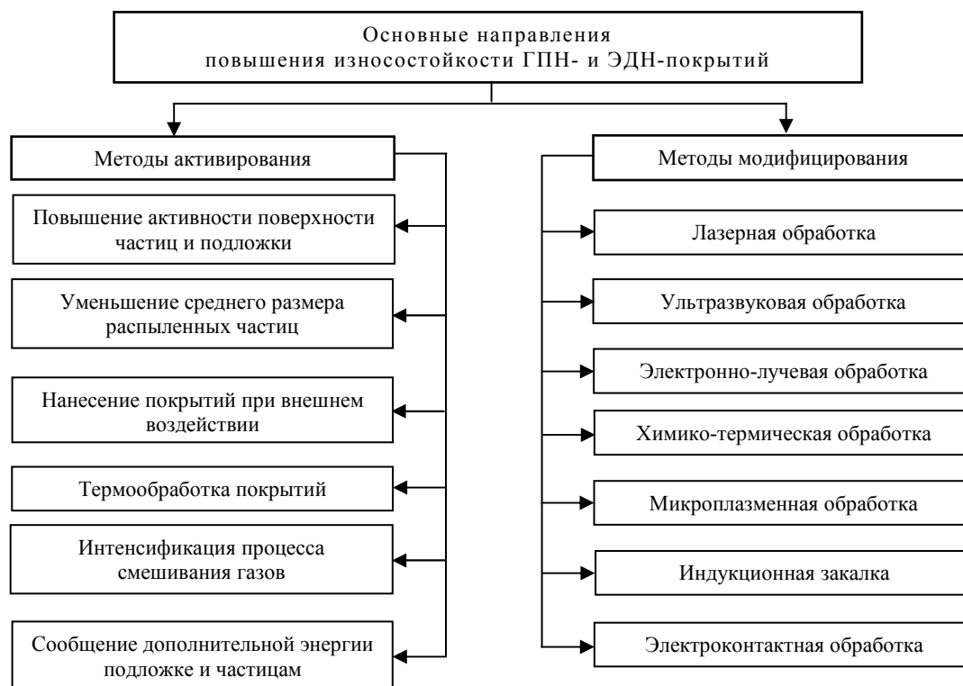
Рисунок 3 – Основные направления повышения износостойкости ГПН- и ЭДН-покрытий
