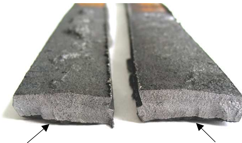
Рис. 2. Хрупкое разрушение образцов из стали 15X5M при механической обработке (излом показан стрелками)
