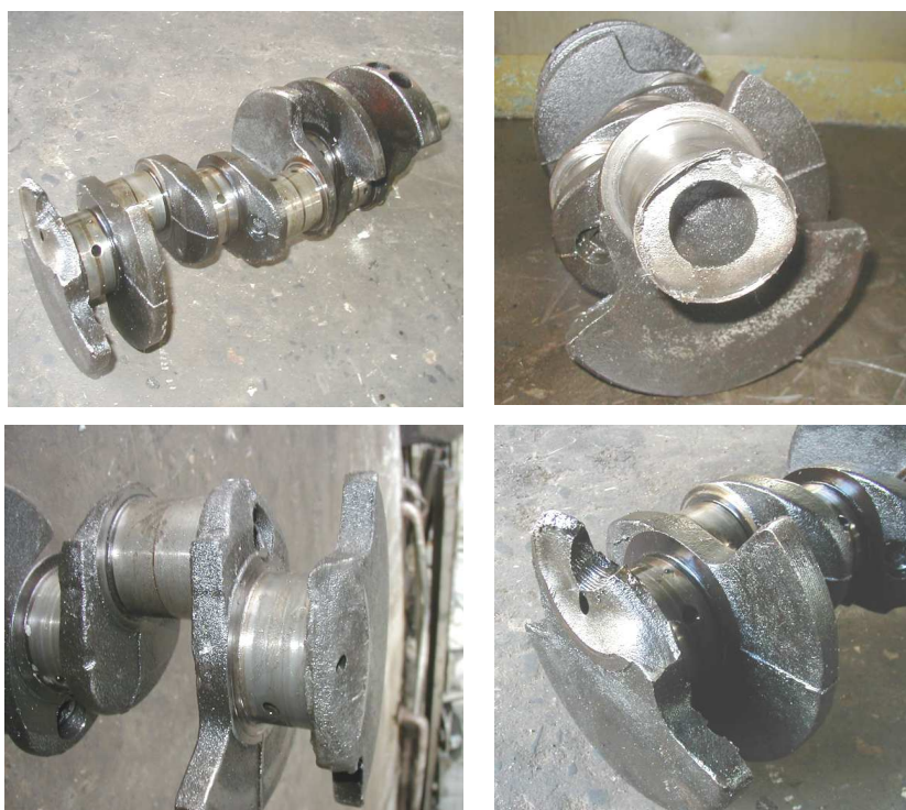
Рис. 1. Характерные виды отказов и поломок коленчатых валов двигателей
