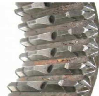
**Рисунок 2. – Конфигурация заходных кромок и форма боковых поверхностей зубьев подвижной зубчатой полу муфты**
