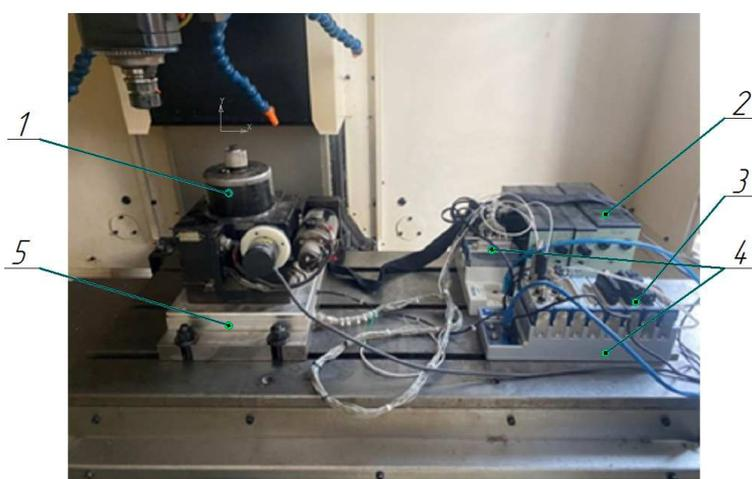
1 – установочное приспособление; 2 – усилители сигналов акселерометров; 3 – функциональные модули сбора данных; 4 – шасси сбора данных; 5 – первичный тензометрический преобразователь
