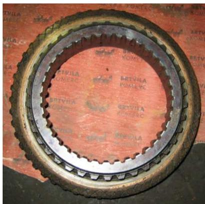
**Рисунок 6. – Односторонний износ фрикционного слоя ведомого диска**
