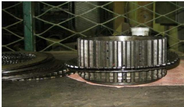
**Рисунок 5. – Заедание покоробленного диска на шлицах фрикционной муфты**
