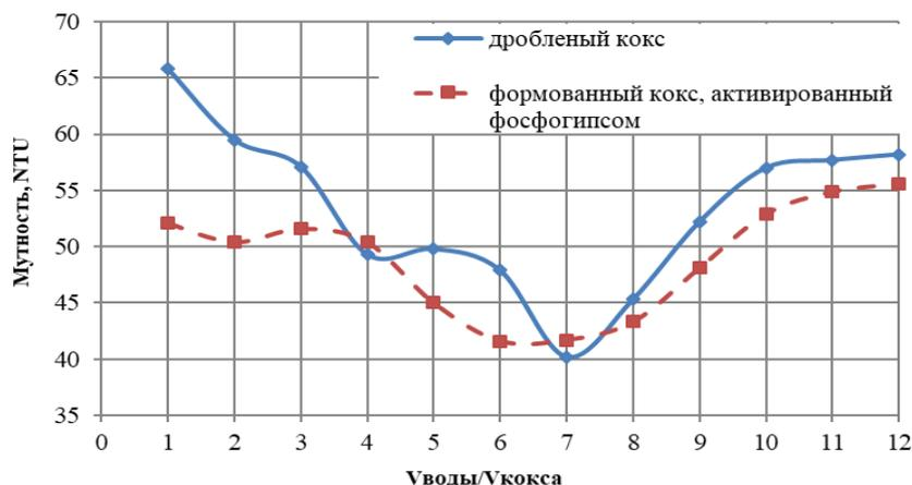
Рисунок 4. – Изменение мутности очищенной воды в единицах NTU с увеличением объемной кратности воды с нефтью, пропущенной через образцы активированного кокса
