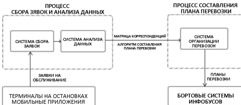
Рисунок 4. – Общая схема потока данных в информационно-транспортной системе
