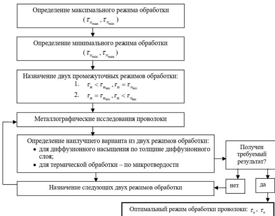
Рисунок 2. – Методика оптимизации режимов диффузионного насыщения и термической обработки проволоки в условиях электроконтактного циклического электронагрева
