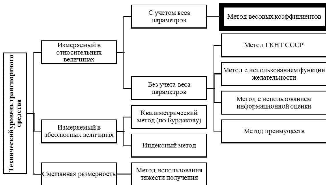
Рисунок 2. – Классификация методов определения технического уровня транспортного средства в зависимости от размерности коэффициента технического уровня
