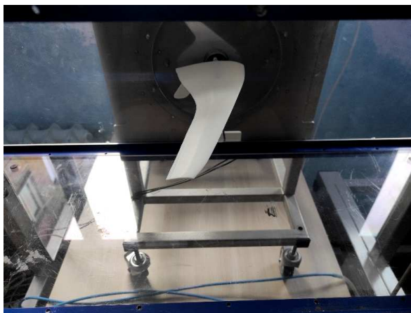
Рисунок 4. – Обдуваемая модель, установленная на консоль аэродинамических весов лабораторного стенда НТЦ-19.02 «Аэродинамическая труба»
