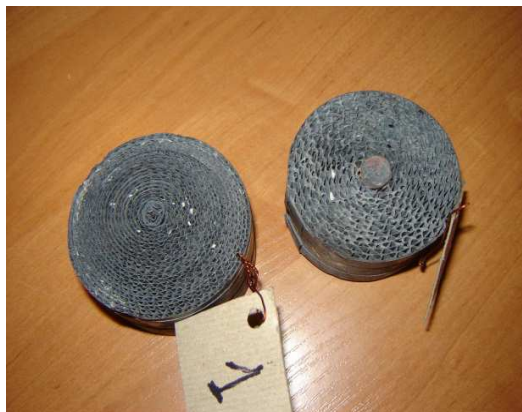
Рисунок 2. – Каталитические блоки для мотоциклетного двигателя, изготовленные из металлической фольги
