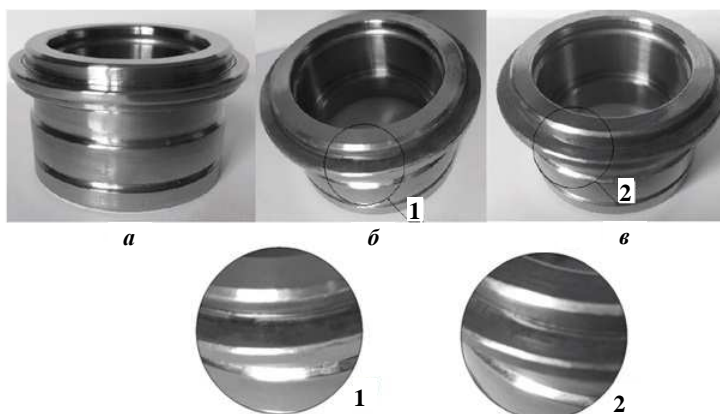
а – до начала эксперимента; б – через 48 ч; в – через 336 ч; 1; 2 – очаги коррозии
