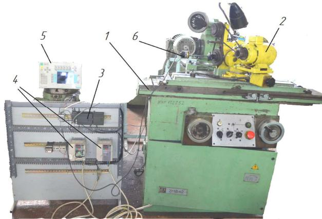
Рисунок 4. – Стенд на базе универсально-заточного станка модели 3М642
