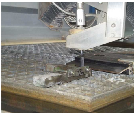
Рис. 8. Установка исследуемого образца. Рабочий стол гидрорежущей машины ЛСК-400-5
