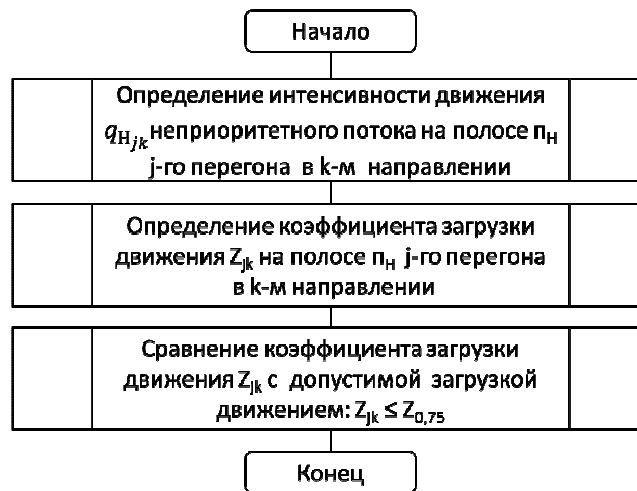
Рисунок 3. – Оценка состояния ТП на неприоритетных полосах
